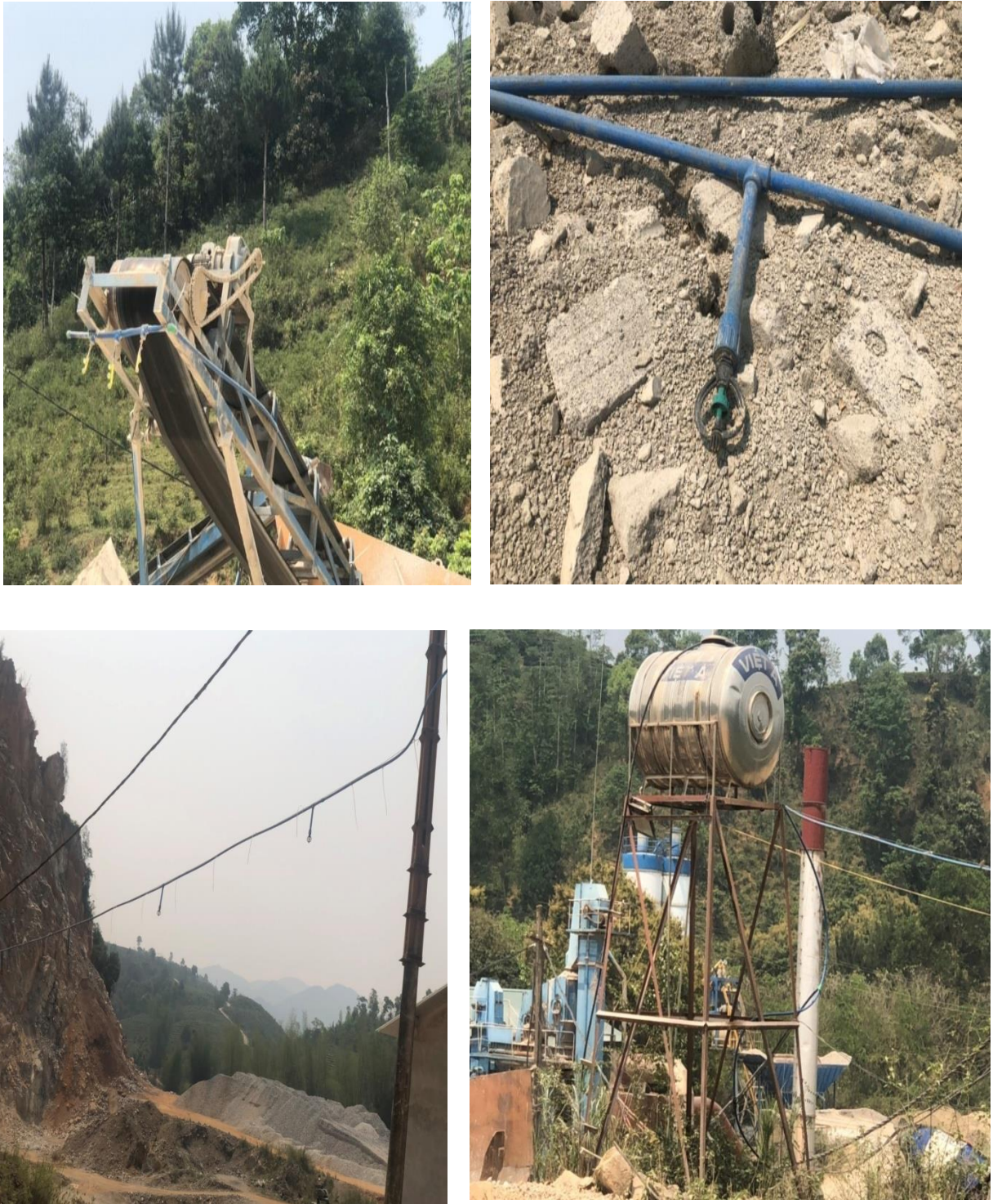
Hình 9: Một số hình ảnh hệ thống chống bụi bằng phun sương cao áp tạo ẩm
