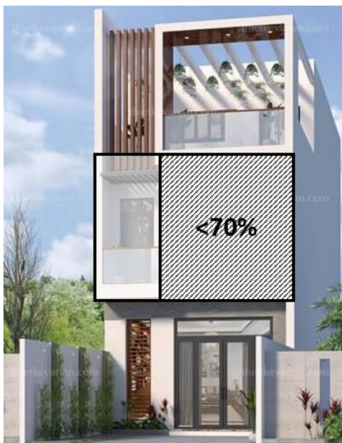
Hình 1. Quy định tỉ lệ phần buồng hoặc lô-gia trên mặt đứng công trình
