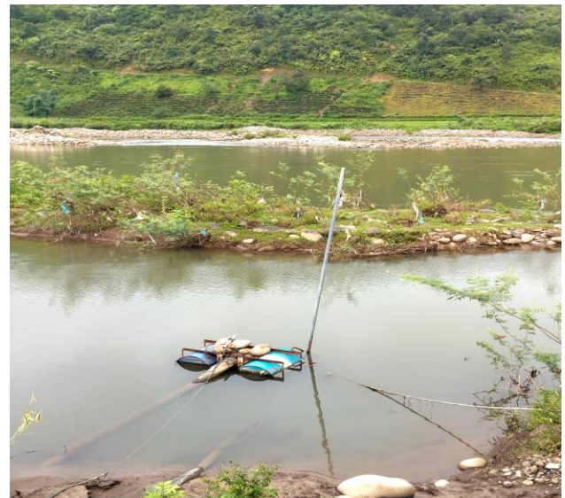
Bơm cấp nước cho dây truyền chế biến
