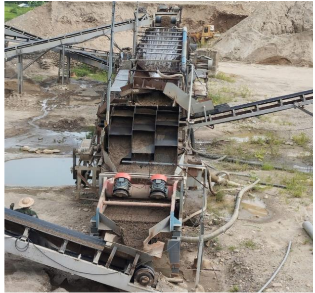
Giàn ống phân phối nước cho sàng rung số 2
