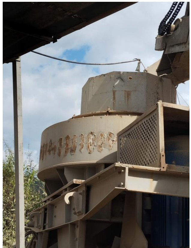
Ống phân phối nước tưới dập bụi tại máy nghiền cát
