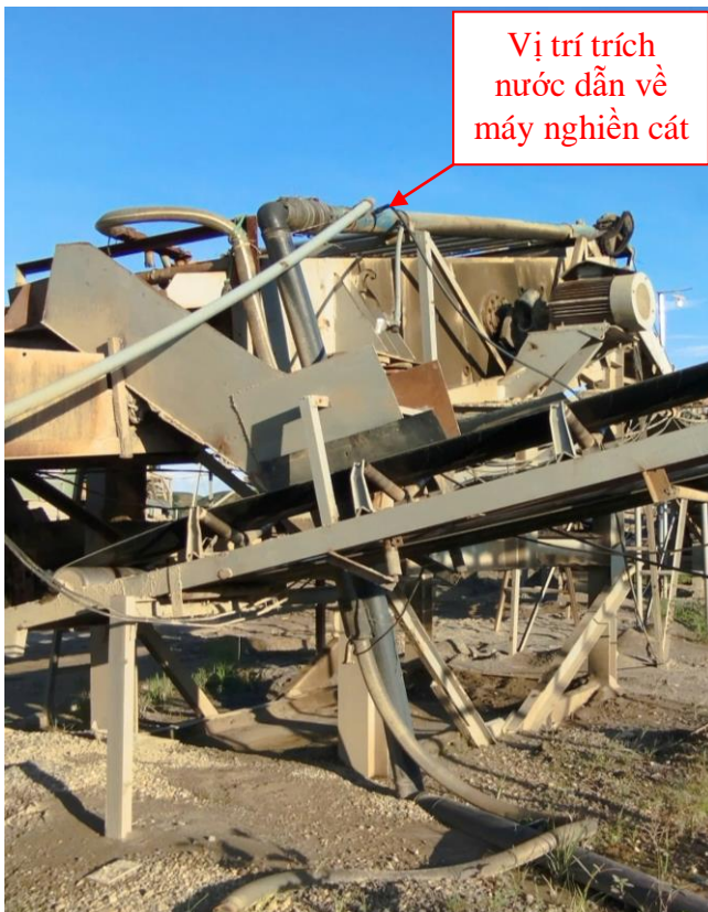
Ống phân phối nước tưới dập bụi tại máy nghiền cát
